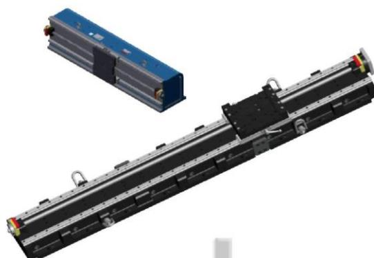
**3** Разделение станины и седла, показанных сверху, на две отдельные рельсы для продольного фрезерования, как показано ниже.
