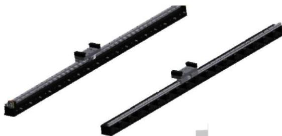
**4** Повторное закрепление суппорта к станине и установка рельсов для режима продольного фрезерования.
